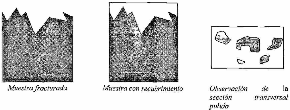
Figura 3.1.- Representación del procedimiento experimental realizado por Mandelbrot.
