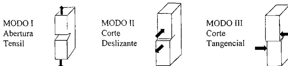
Figura 4.3.- Modos de deformación de grieta.
