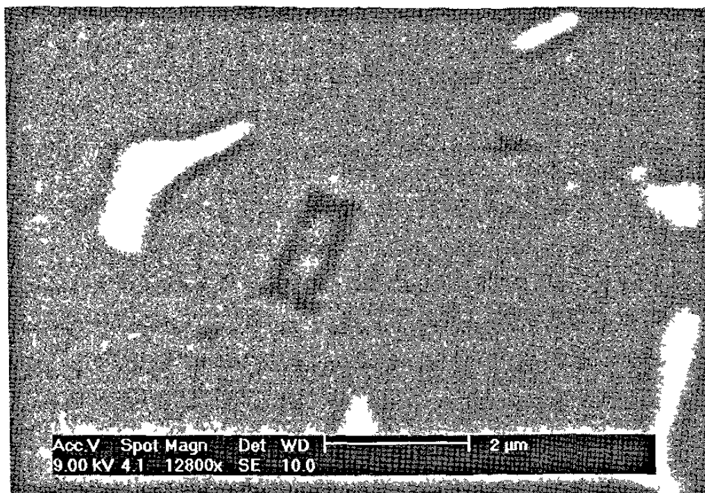
Figura 6.3.5. Imagen tomada en SEM de precipitado C4, Mg 2 Si (Obscuro).
