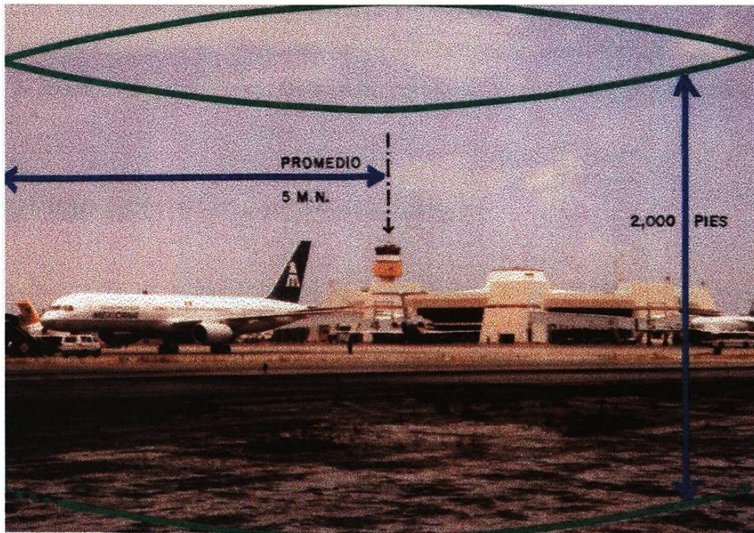
Fig.9.2 Área de control de aeródromo
