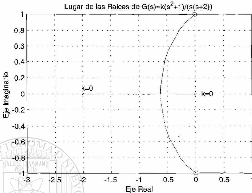
Figura 4.1.3 Lugar de las Raíces de un sistema con dos ceros y dos polos
