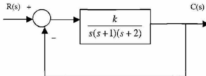
Figura 4.5.2 Sistema de Control con Retroalimentacion Unitaria
