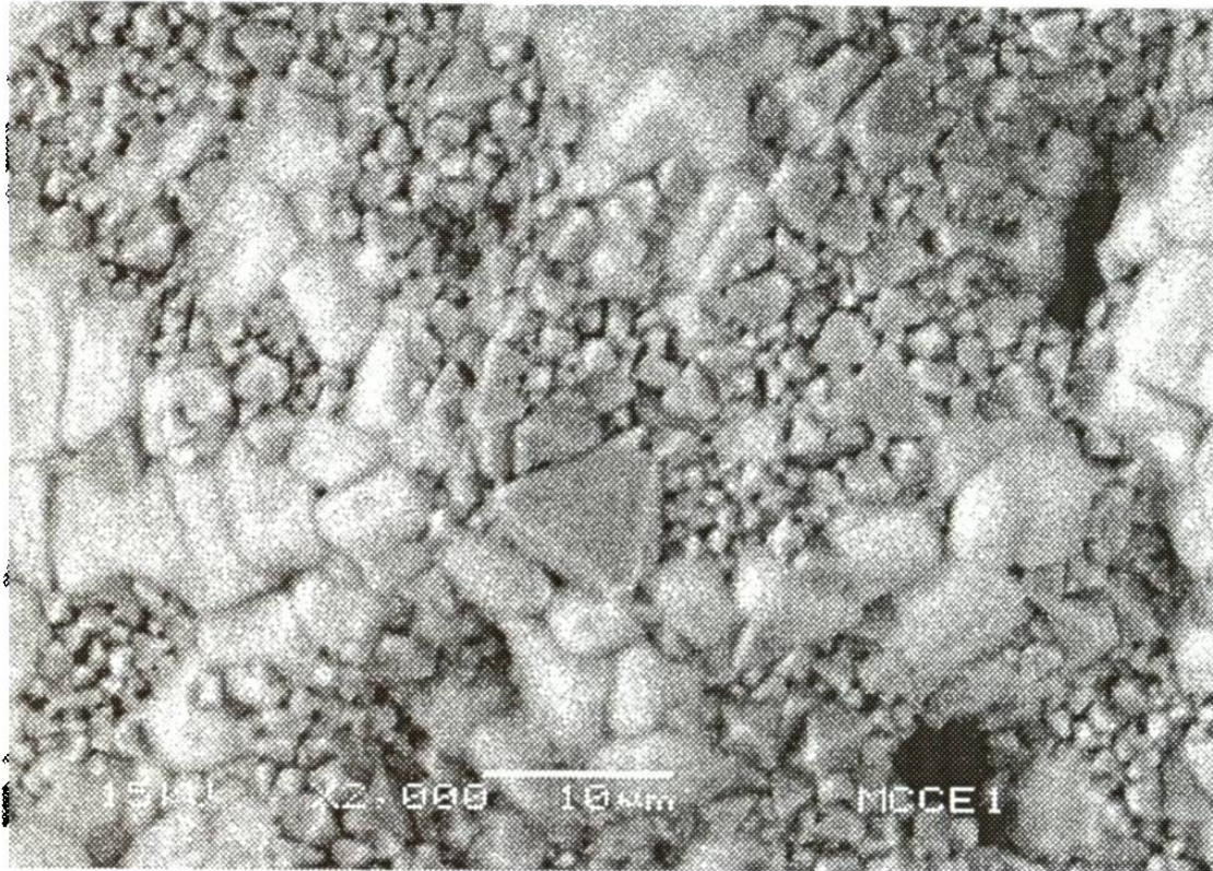
Figura 5.23 Imágen de MEB de la muestra Mcce-1 donde se observa dos tipos de morfología, un grano pequeño ( MgAl_2O_4 ) de coloración gris y variando su tamaño de 1 a 5 \mu m y un grano mayor a 10 \mu m (aluminatos de calcio) de coloración clara.
