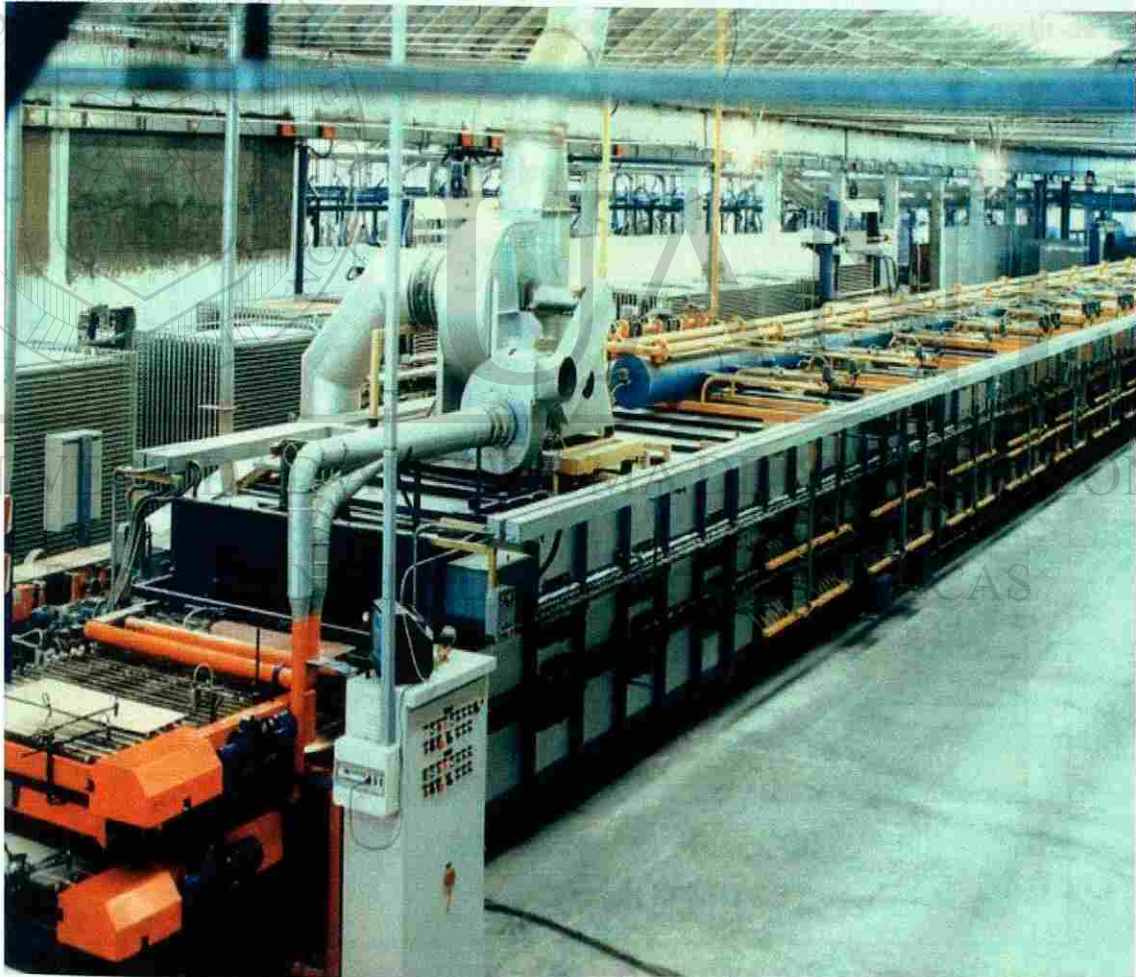
Figura 12. Horno de rodillos utilizado en la cocción del gres porcelánico.
