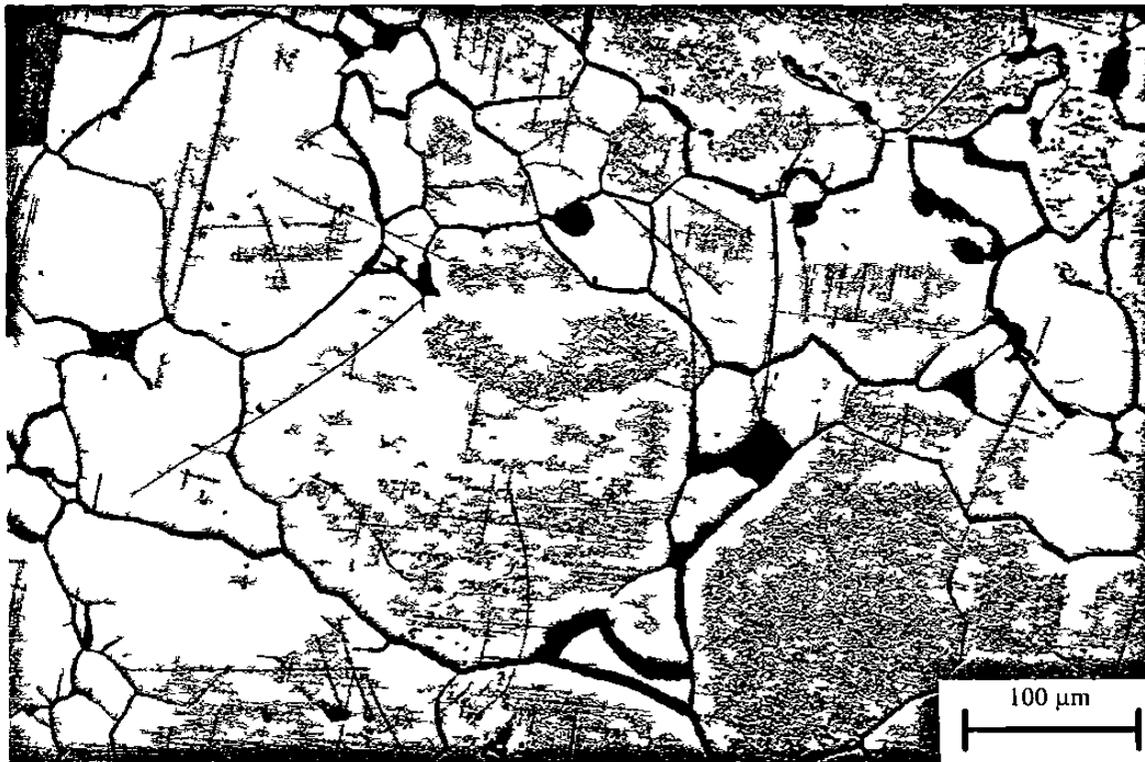
Fig. 5.4 Fotografía de microscopía óptica de CaZrO<sub>3</sub> procesado por electrofusión.
