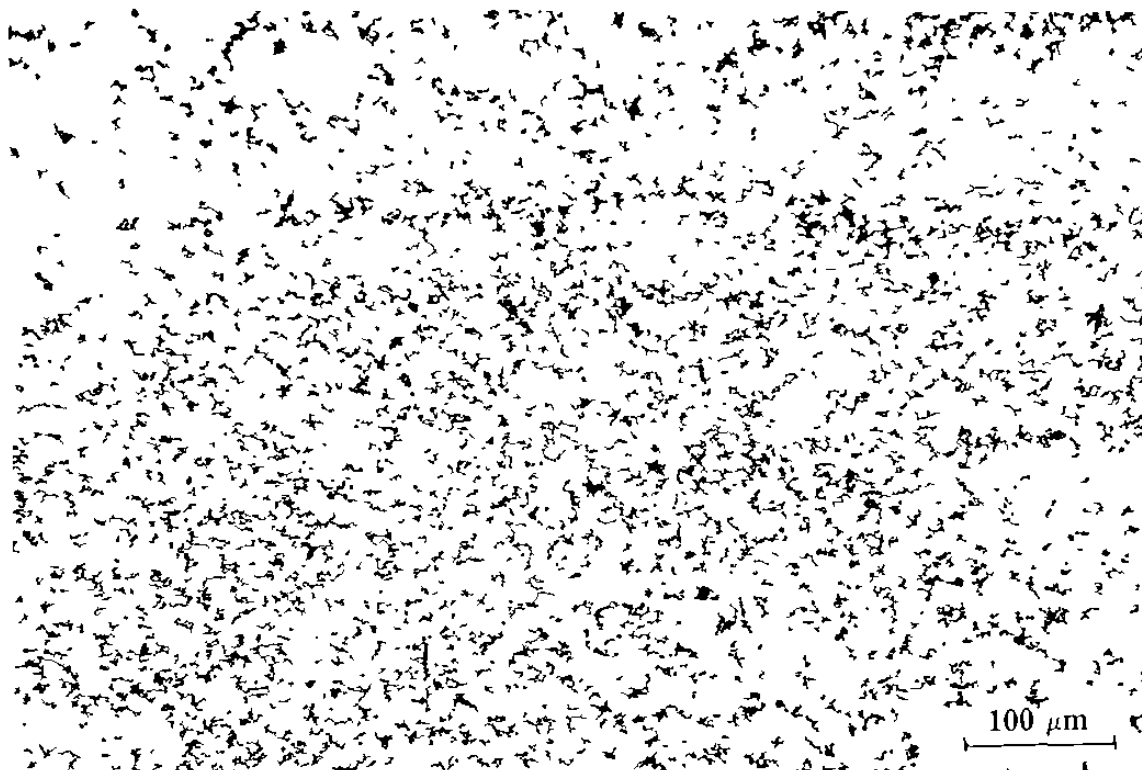
Figura 36. Microestructura de tamaño de grano de la muestra 2 del grupo 1 en dirección de laminación.
