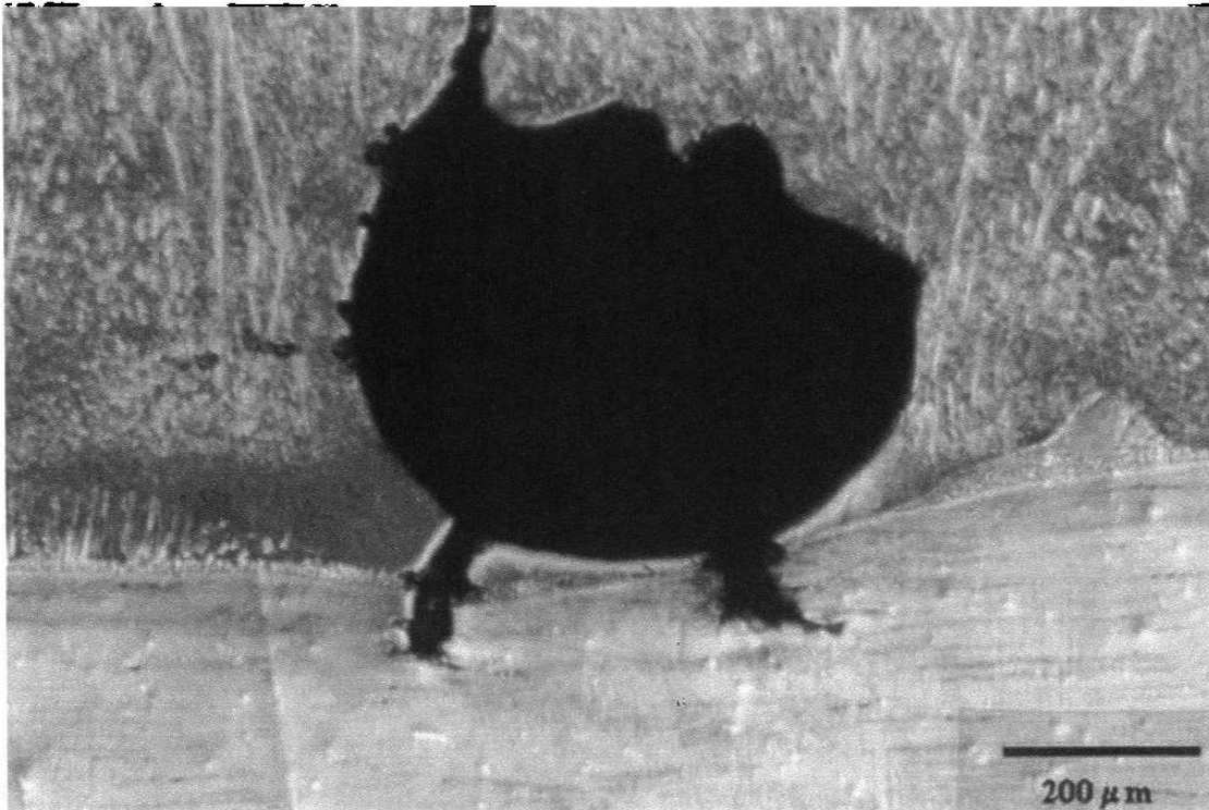
Figura A7 Microestructura correspondiente a la muestra 2 y después de 40 ciclos de enfriamiento en agua. Esta imagen presenta un poro originado durante el proceso de deposición del recubrimiento duro por medio de soldadura. Las dos grietas que aparecen en la parte inferior del poro se formaron durante el ciclado térmico. Esta imagen fue obtenida en el microscopio óptico. Se utilizó un ataque electroquímico en el que se empleó ácido oxálico como electrolito.
