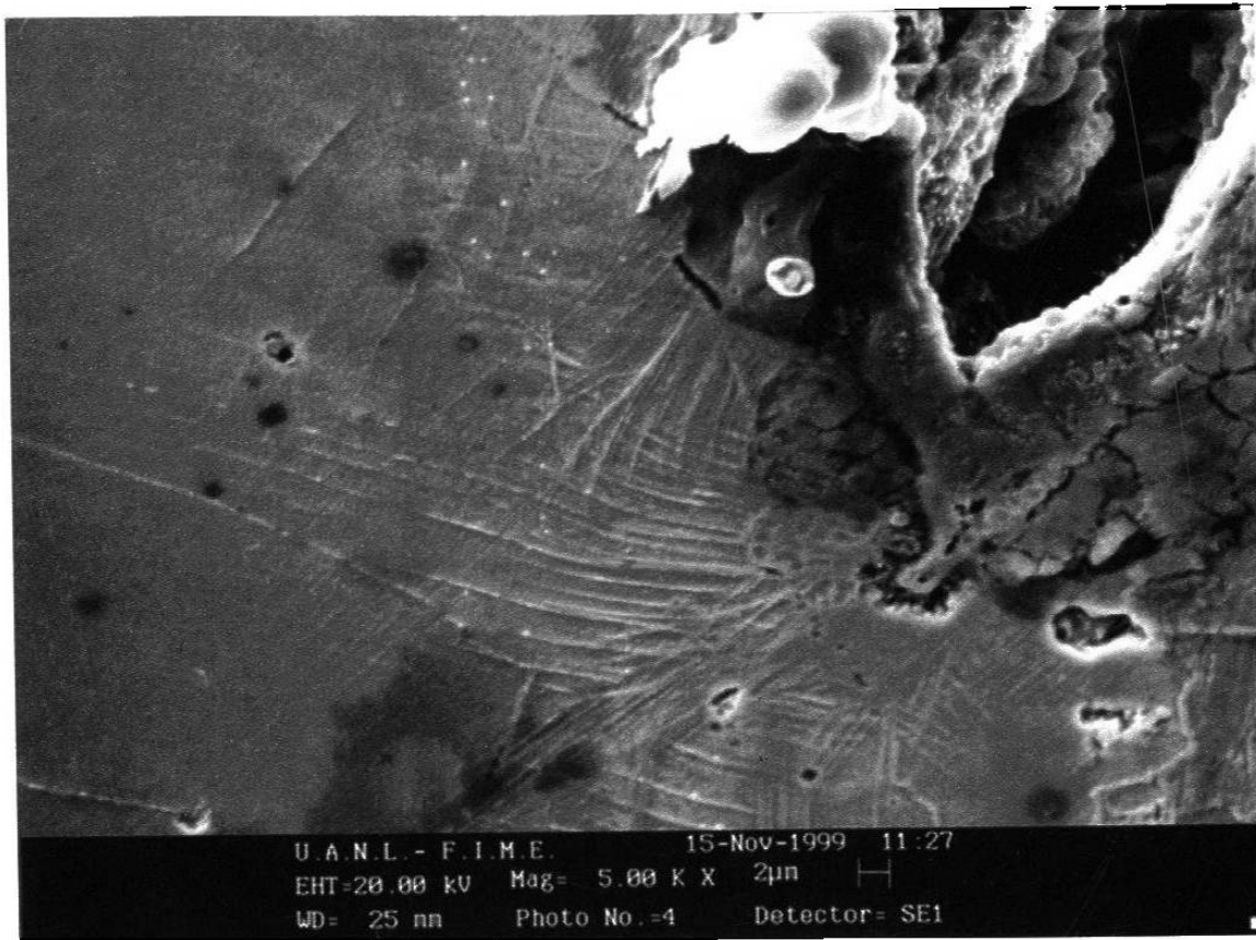
Figura A4 Microestructura correspondiente a la muestra 1 después de 20 ciclos de enfriamiento en aire. Esta imagen presenta el final de una grieta del recubrimiento, la punta de la grieta se encuentra en la interfase entre el recubrimiento y el acero inoxidable, en este ultimo se puede observar líneas de deformación plástica. Esta imagen fue obtenida en el microscopio electrónico de barrido (SEM) El ataque químico utilizado fue una solución de 5 ml HCl , 1g ácido pícrico y 100 ml de alcohol etílico.
