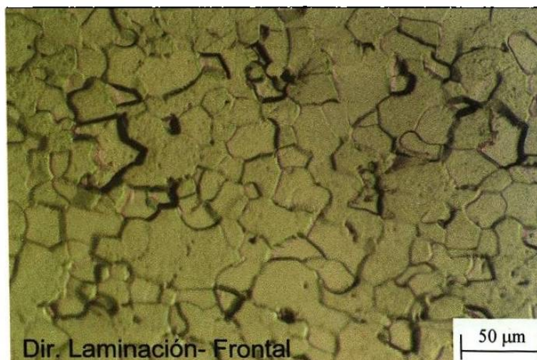
Figura 5.1.- Microestructura del acero libre de intersticiales.
