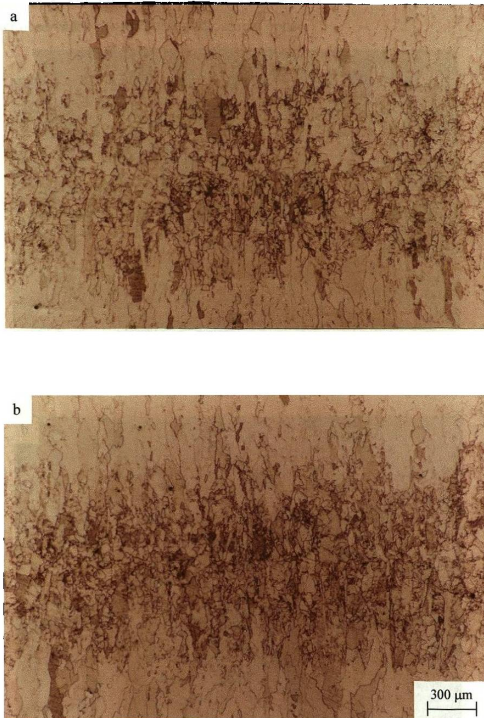
Figura 5.40.- Microestructura de la parte central de la soldadura, a) Muestra decapada, (10.88 kA), b) muestra D (12.32 kA).
