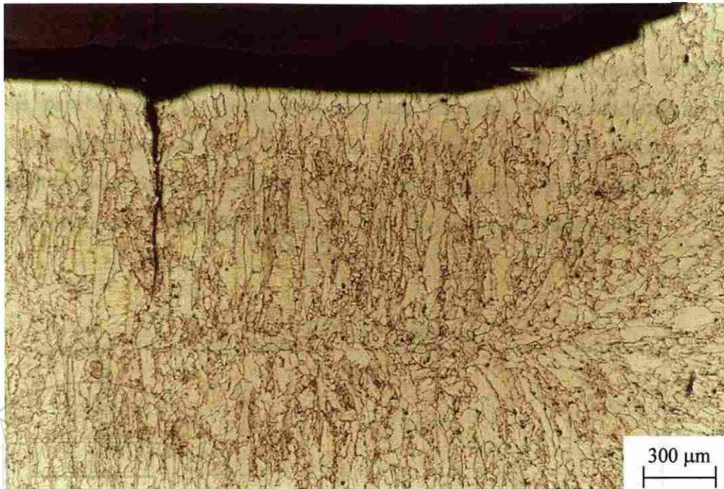
Figura 5.54.- Grieta en la cara que se encontraba en contacto con el electrodo inferior, soldadura con 13.96 kA de la muestra D.
