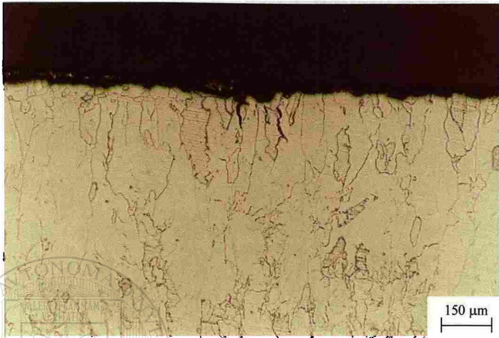
Figura 5.52.- Grietas pequeñas en la cara que se encontraba en contacto con el electrodo inferior, soldadura con 11.6 kA de la muestra decapada.
