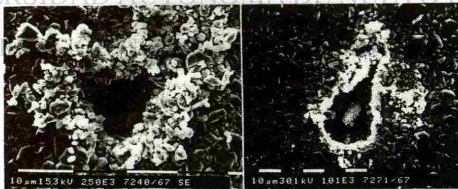
Figura 2.13.- Formación de la fase Fe-Zn en la frontera de grano de la ferrita (17) .
