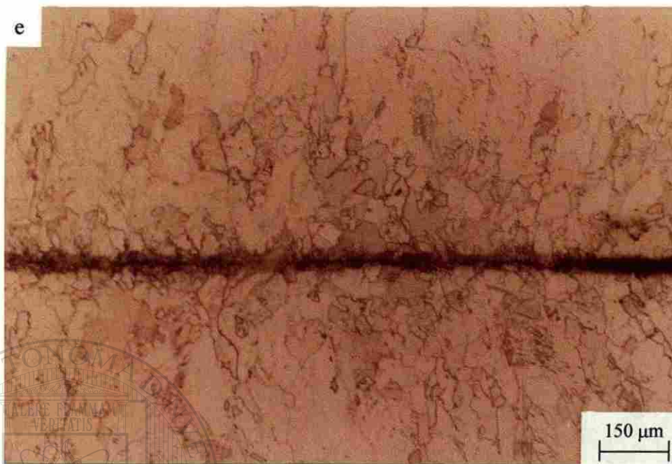
Figura 5.37.- Zona soldada en muestra decapada (10.0 kA) (a), b) muestra A (10.08 kA), c) muestra B (10.20 kA), d) muestra C (10.08 kA), e) muestra D (10.12 kA).
