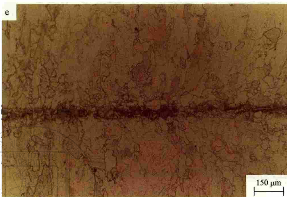
Figura 5.38.- Zona soldada en muestra decapada (10.24 kA) (a), b) muestra A (10.28 kA), c) muestra B (10.32 kA), d) muestra C (10.32 kA), e) muestra D (10.28 kA).
