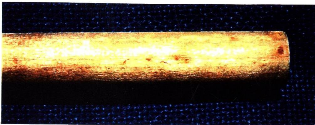
Figura 6.29. Acero Am1 que muestra ataque por picaduras.
