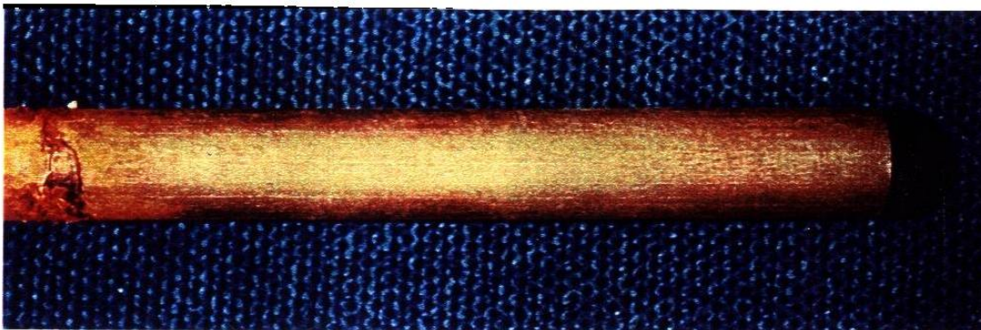
Figura 6.30. Acero Az carburizado que no estuvo sujeto a la adición de cloruros. La superficie no muestra signos de ataque localizado.
