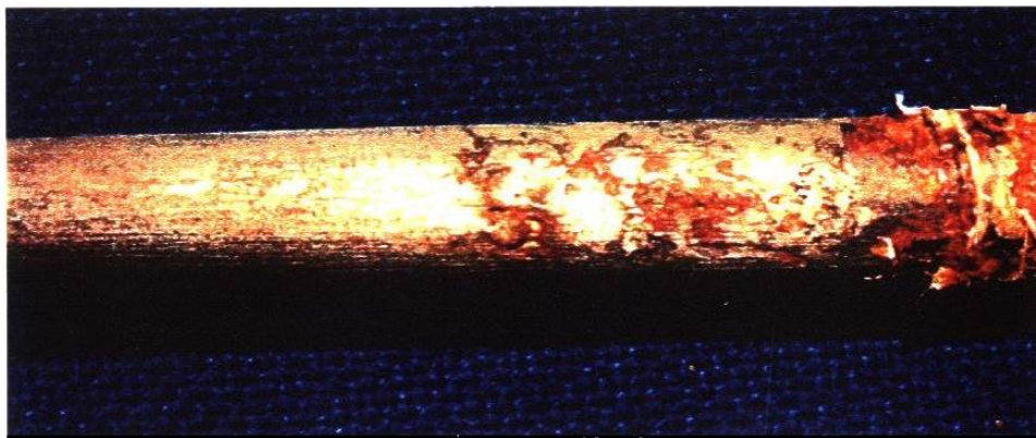
Figura 6.24. Acero B carburizado que muestra un ataque severo debido a los cloruros.
