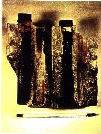
Figura 6.10. Mortero con acero Az tratado superficialmente sin adición de cloruros. Obsérvese como no existen manchas (productos de corrosión) en las paredes del mortero que estuvieron en contacto con el metal.
