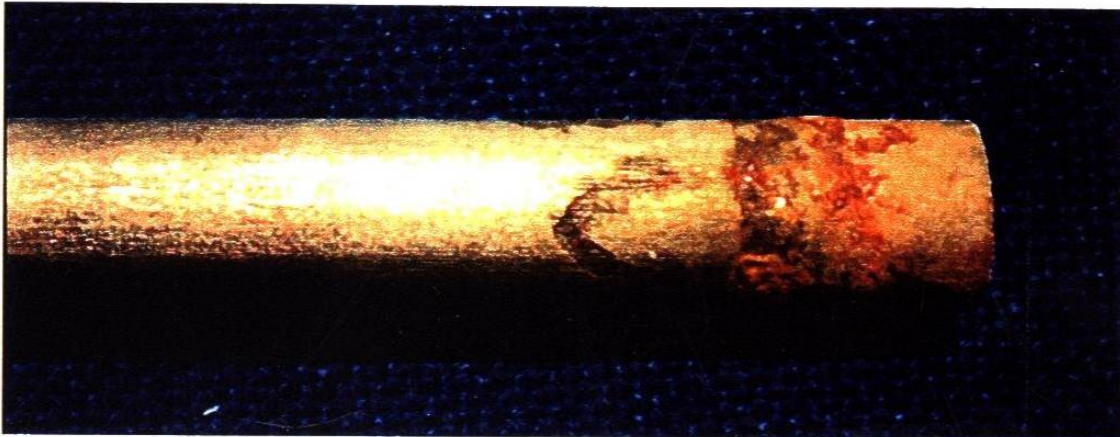
Figura 6.28. Acero Am carburizado que muestra el desprendimiento de capas superficiales de metal en una zona muy localizada
