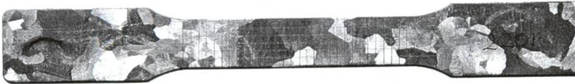
Figura 6.3 Imagen de la muestra preparada con la milimalla de 2mm x 2mm y atacada químicamente con HCl al 8%.
