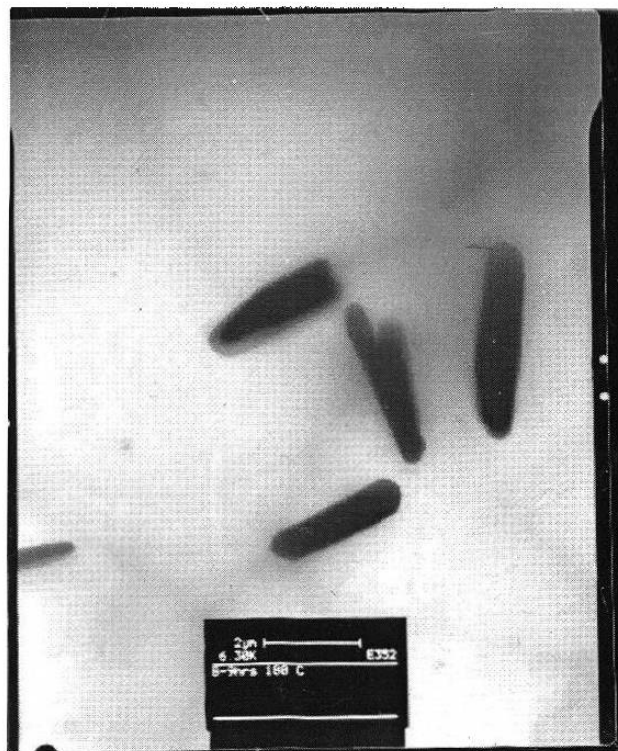
Figura 5.24.- Precipitados en una muestra con máxima dureza 30,000x
