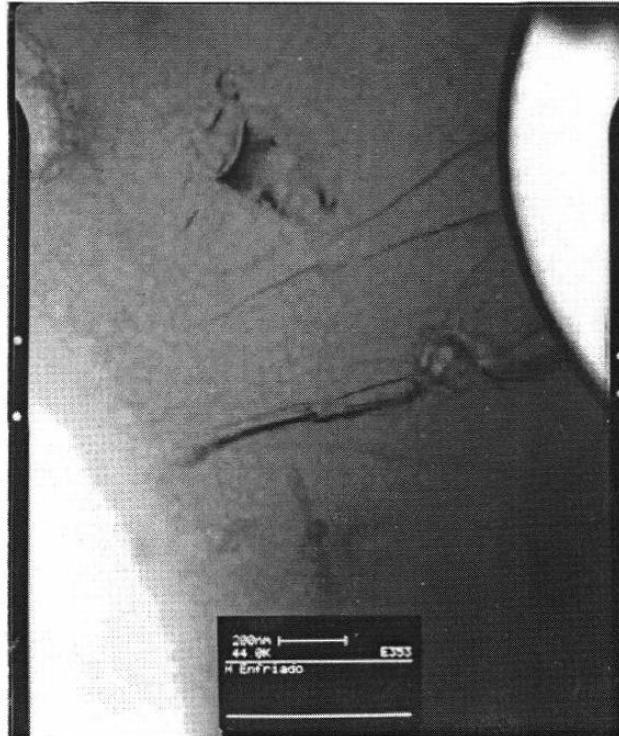
Figura 5.17.- Precipitado en una muestra sobresaturada enfriada más lentamente 44,000X campo claro
