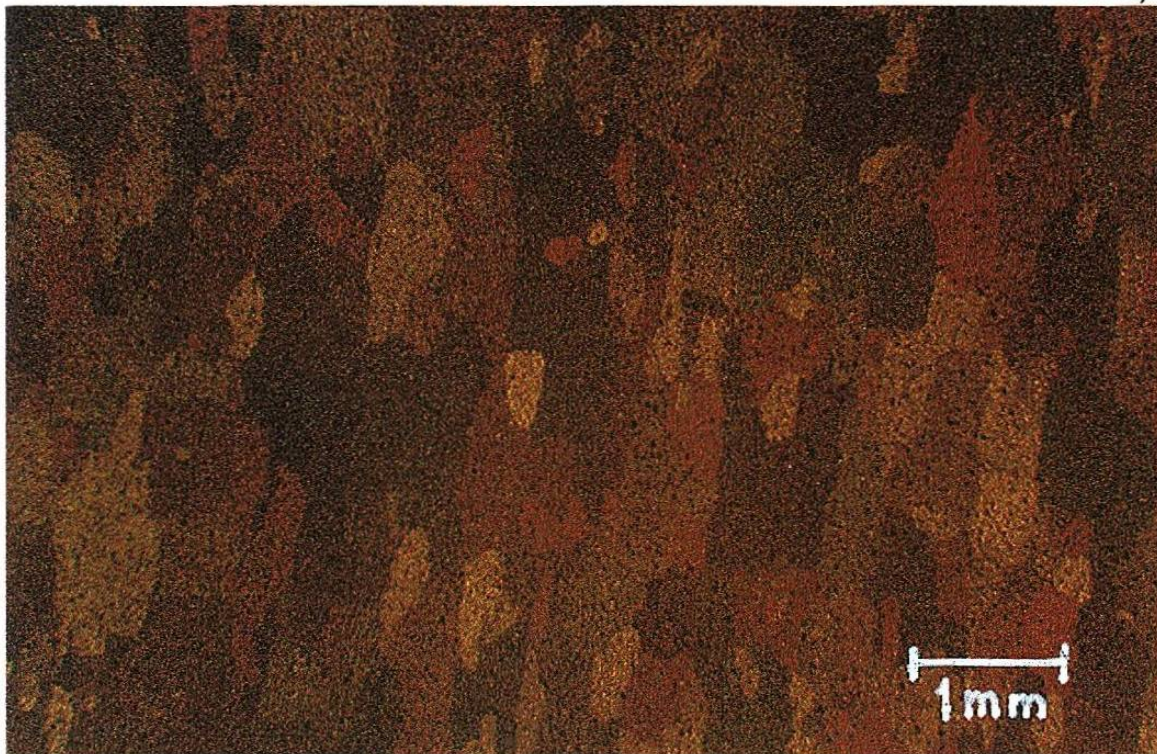
Figura 4.1. – Microestructura de una aleación de aluminio 6063 extruida en dirección: a) normal, b)longitudinal al extruido
