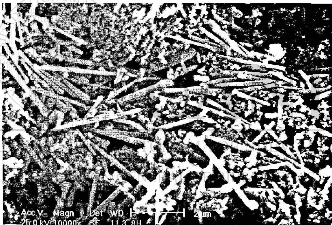
Fig. 5,14 Micrografía de electrones secundarios de la ceniza a 1400^{\circ}\text{C} por 8 horas.
