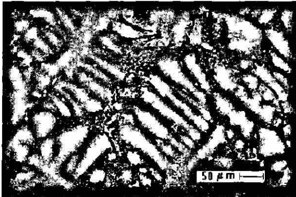
Figura. 1 Muestra atacada durante 4 min con ácido Fosfórico a 70°F, 200 X.
