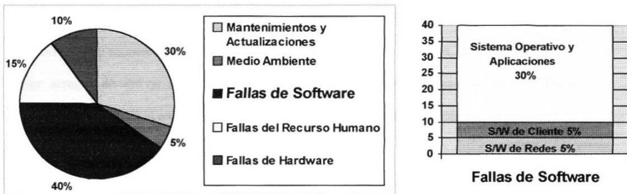
Figura 1. Las distintas causas de fallas de sistemas
