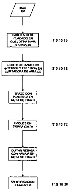
DIAGRAMA DE FLUJO PARA LA FABRICACION DE ANILLOS FAD
