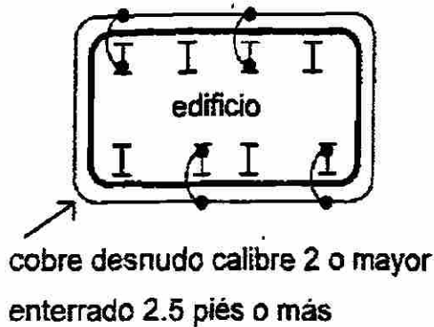
Anillo de tierra eléctrica
