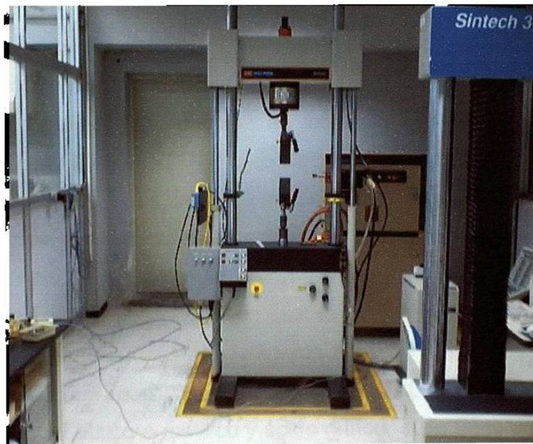
**FIGURA 4.2.1** Máquina universal servo hidráulica.
