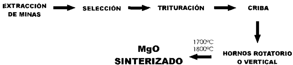
Fig. 5.4.- Diagrama de la obtención de MgO sinterizado por el proceso de quemado directamente.
