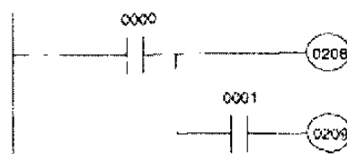
Figura 6.5 Paralelo de dos o más bobinas.
