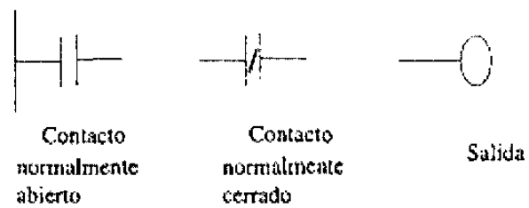
Figura 6.1 Símbolos básicos del esquema de contactos.
