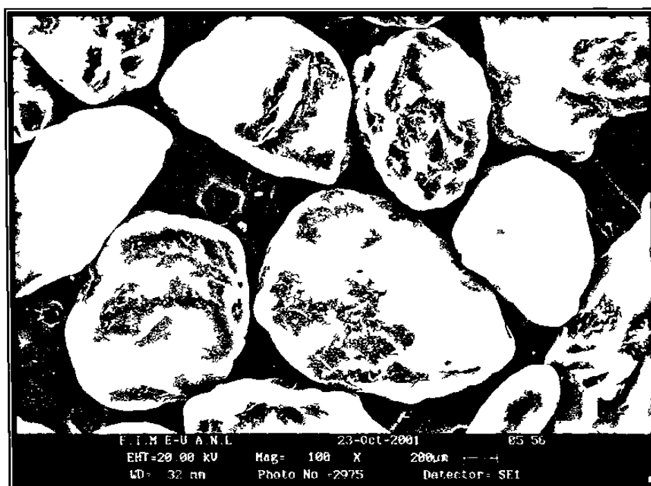
Imagen 14.- Microfotografía de la arena sílica F 20/40 obtenida por Microscopía Electrónica de Barrido (SEM) con una amplificación de 100X.
