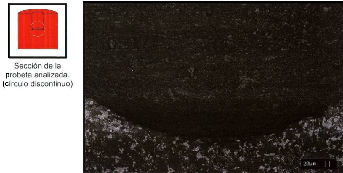
Figura 53. Micrografía de MEB de una probeta seccionada de la formulación 2C (3.5% \text{FeAl}_2\text{O}_4 ). 350X. Técnica de electrones retrodispersados.
