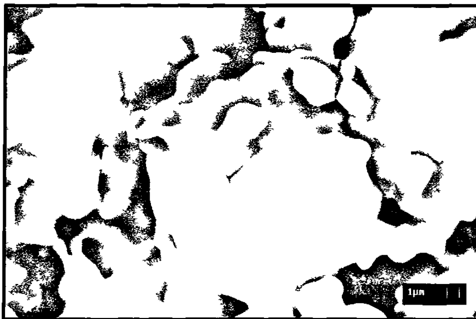
Figura 58. Imagen de MEB del circonato de calcio prefabricado. 10000X. Técnica de electrones retrodispersados.
