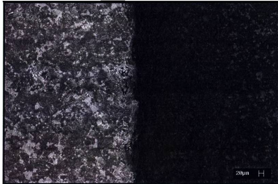
Figura 54. Micrografía de MEB de una probeta seccionada de la formulación 2C (3.5% \text{FeAl}_2\text{O}_4 ). 350X. Técnica de electrones retrodispersados.
