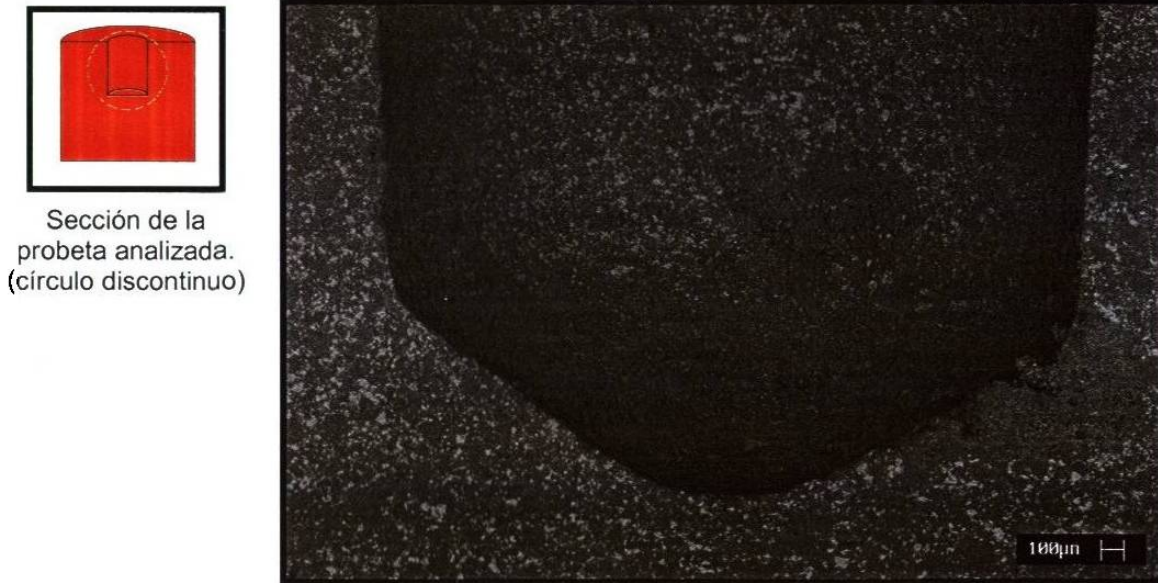
Figura 52. Micrografía de MEB de una probeta seccionada de la formulación 2C (3.5% \text{FeAl}_2\text{O}_4 ). 100X. Técnica de electrones retrodispersados.
