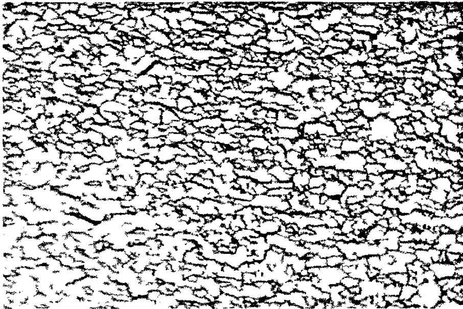
Fig. A-92. Crecimiento de grano del acero SAE 1006, ciclo de recocido a 710°C X 12 horas de proceso con zona de precalentamiento a 400°C X 1 hora, visto a 200X y con un ataque de Nital al 5%
