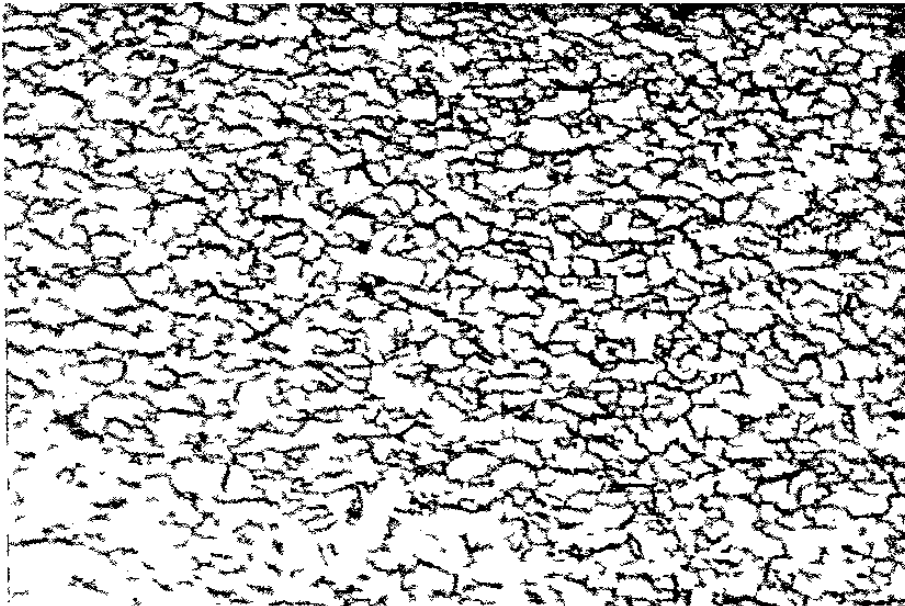
Fig. A-91. Crecimiento de grano del acero SAE 1006, ciclo de recocido a 710°C X 9 horas de proceso con zona de precalentamiento a 400°C X 1 hora, visto a 200X y con un ataque de Nital al 5%
