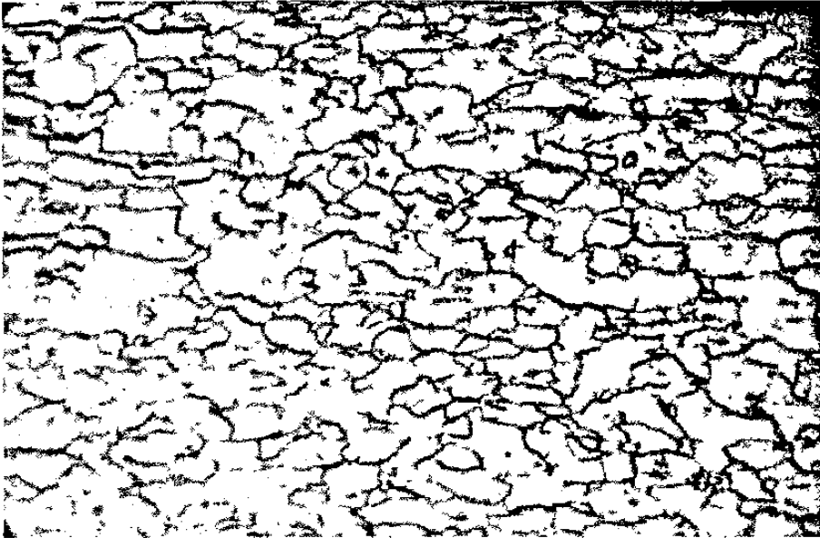
Fig. A-60. Crecimiento de grano del acero SAE 1006, sometido a un ciclo de recocido a 670°C con 0.50 horas de proceso con zona de precalentamiento a 400°C X 1hora, a 400X y con un ataque de Nital al 5%.
