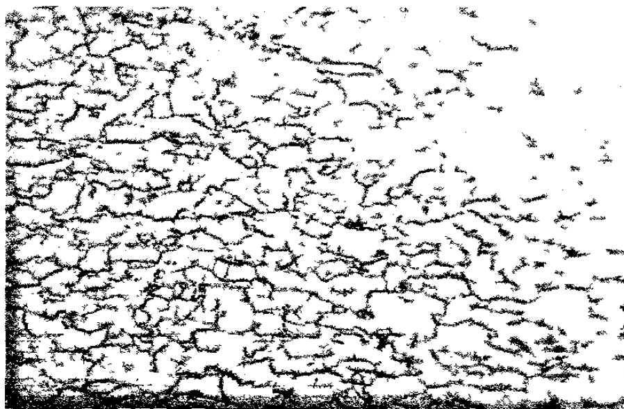
Fig. A-77. Crecimiento de grano del acero SAE 1006, ciclo de recocido a 710°C X 0.50 horas de proceso, visto a 400X y con un ataque de Nital al 5%
