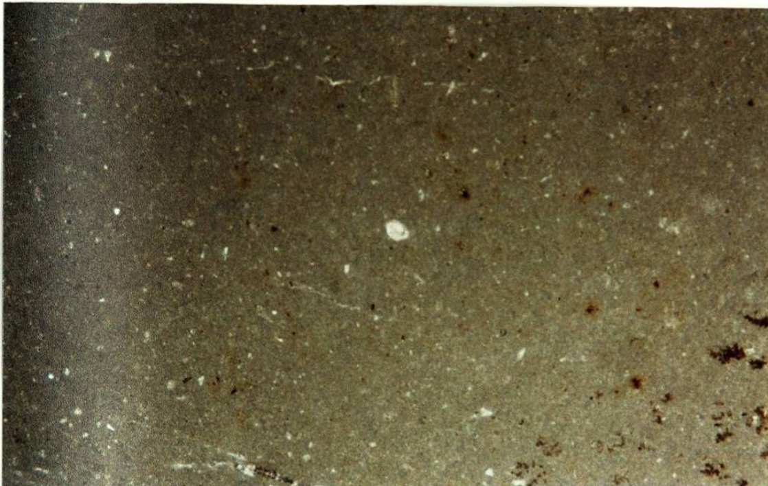
Micrografía 14. Sección delgada LY-70 Cu. "Mudstone" micrítico con escasos bioclastos. (x 2.5)
