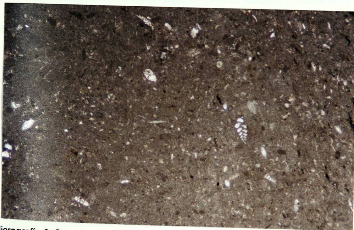
Micrografía 8. Sección delgada LY-64 Cu. "Mudstone" con biógenos: foraminíferos, espículas de esponjas, placas de briozoarios y conchas de ostrácodos. (x 2.5)
