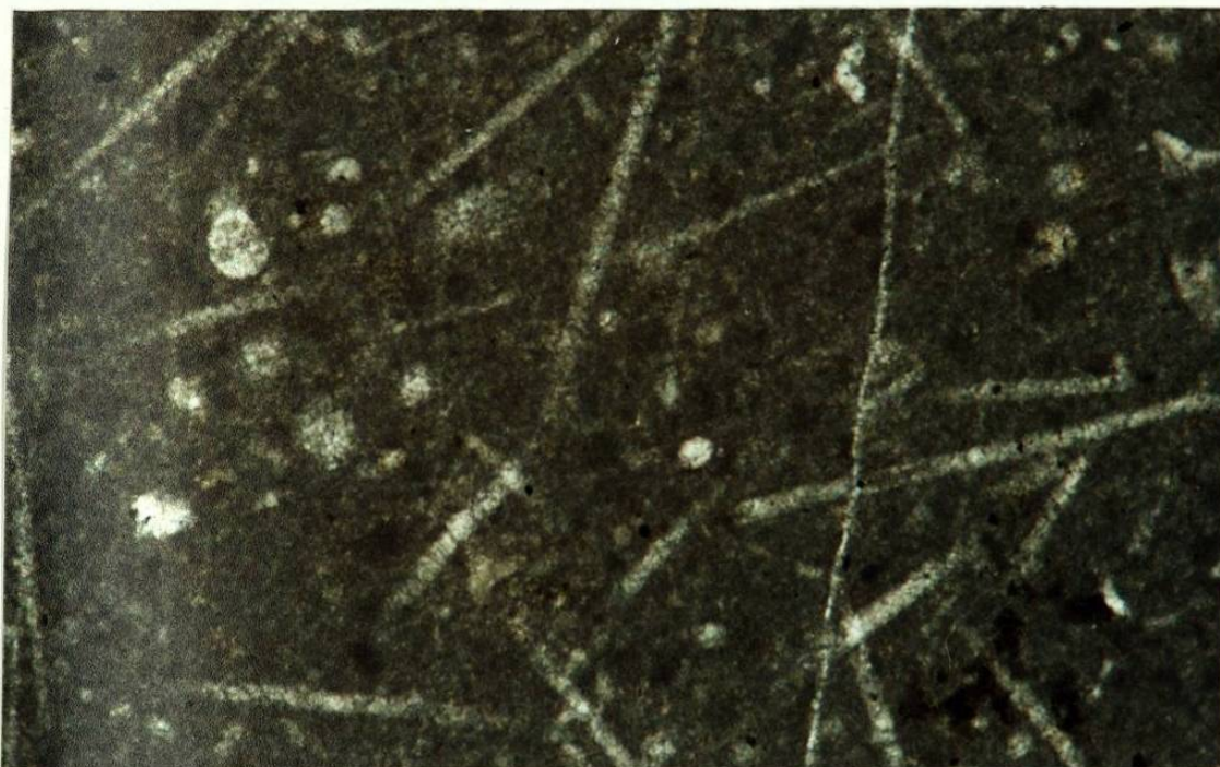
Micrografía 12. Sección delgada LY-67 Cu. "Wackestone" pelágico con espículas de esponjas monoaxonas. (x 10)
