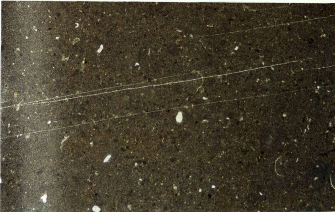
Micrografía 20. Sección delgada LY-85 Cu. "Mudstone" con fragmentos de conchas de ostrácodos. (x 2.5)
