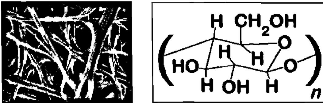
Figura 4.1 Fibras de celulosa y fórmula estructural.
