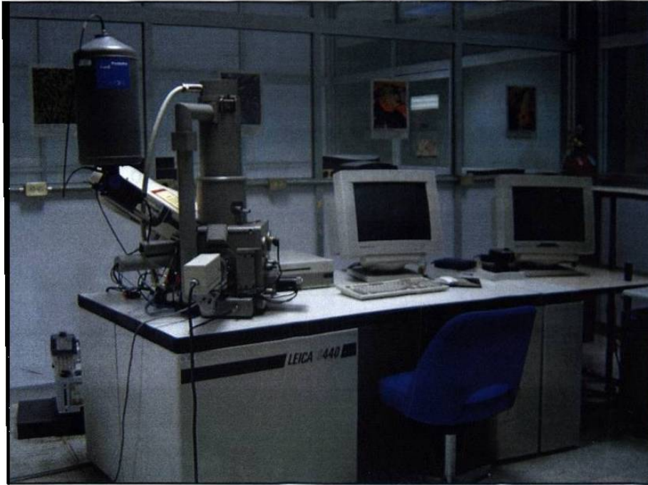
Figura 5.14 Microscopio electrónico de barrido LEICA S440
