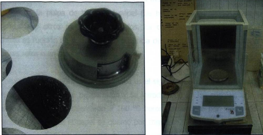
Figura 5.7 Dispositivo de corte de probetas y báscula
