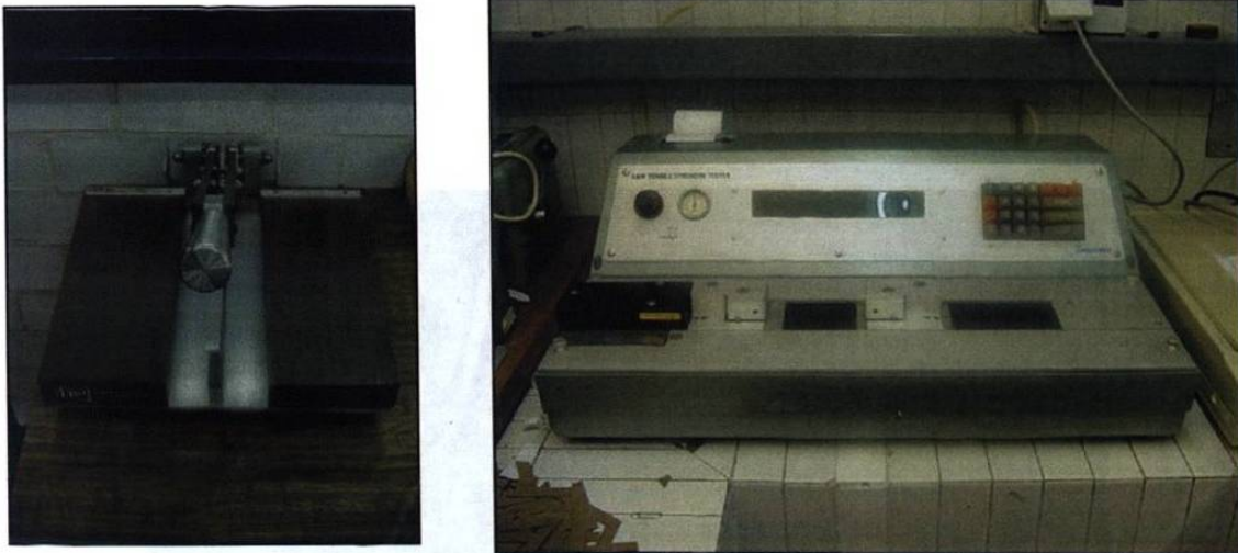
Figura 5.4 Guillotina y máquina de tensión L&W
