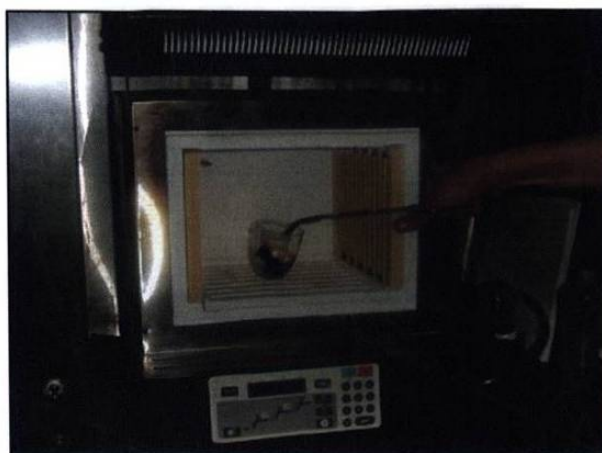
Figura 5.9 Mufla VULCAN 3 –550 NEY de 0 –900 °C, empleada en la prueba de determinación del % de cenizas.
