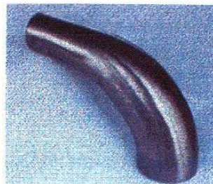
Figura 1-4. Herramienta de formado (mandril) [5].
