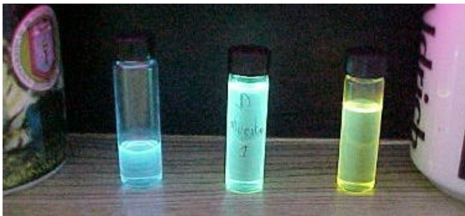
Figura 49. En la fotografía se observan tres muestras de la misma molécula, el heptámero M2R, en solución de cloroformo de diferentes concentraciones, bajo luz UV.
