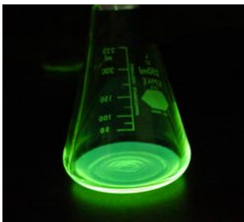
Figura 32. La fotografía muestra la M1A bajo la exposición de radiación ultravioleta, como se puede observar presenta alta fluorescencia, en el color verde.
