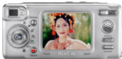
Figura 8. Primera cámara digital que utiliza una matriz activa de OLED. http://www.kodak.com/US/en/corp/display/LS633jhtml .
