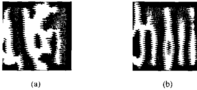
Figura 3.4. Distribución de intensidad, de una onda evanescente, (a) obtenida sin sonda y (b) usando una sonda esférica metálica de 3 mm de diámetro. Escala 8 \times 8 \text{ cm}^2 . Contraste de las imágenes (a) 80%, (b) 90%.
