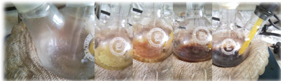
**Figura 2. Aspecto del producto obtenido de la degradación del PET a lo largo del tiempo de reacción.**
