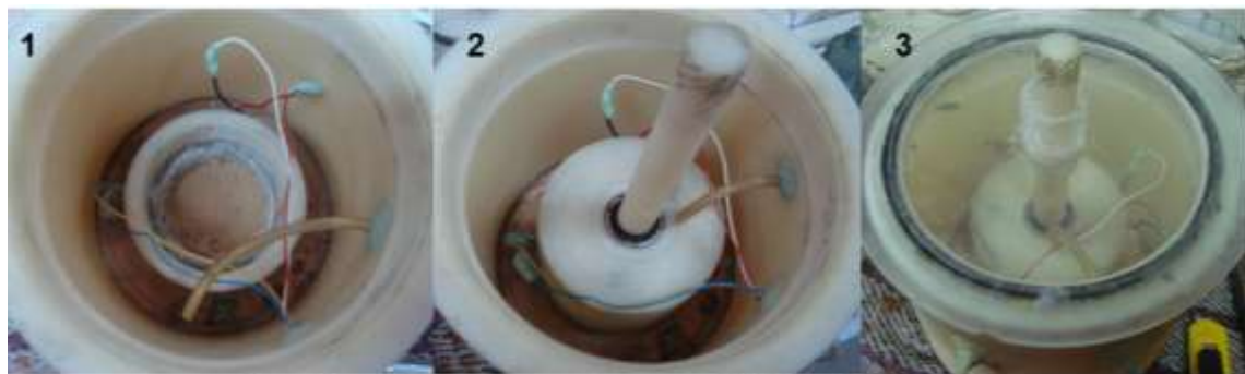
Montaje del portamuestras en el disipador de calor
