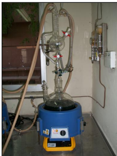
Figura 23. Equipo para destilar disolventes secos.
