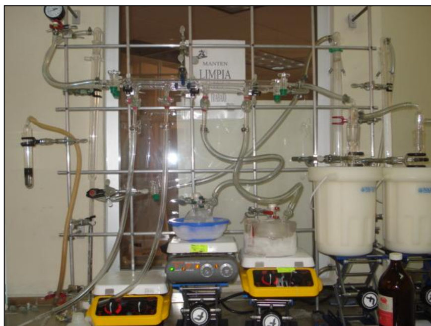
Figura 25. Línea de vacío y nitrógeno Schlenk.
