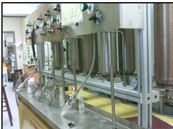
Figura 24. Columnas para el secado de disolventes.
