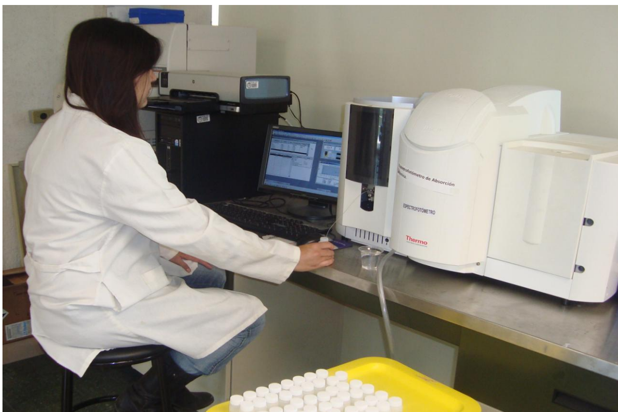
Fotografía 6. Análisis por espectroscopia de absorción atómica (UNICAM Solar modelo 9626).
