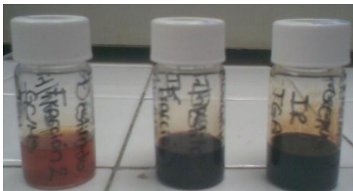
Figura 28. Destilado pesado, destilado ligero y residuo de destilación de la fase orgánica del aceite pirolítico de cáscara de naranja
