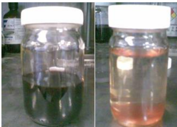
Figura 35. Mezclas de fracciones de destilado con gasolina
