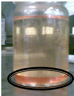
Figura 36. Mezcla de destilado pesado con gasolina
