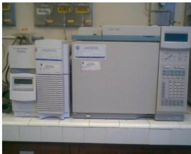
Figura 16. Cromatografía de gases acoplado a espectrómetro de masas
