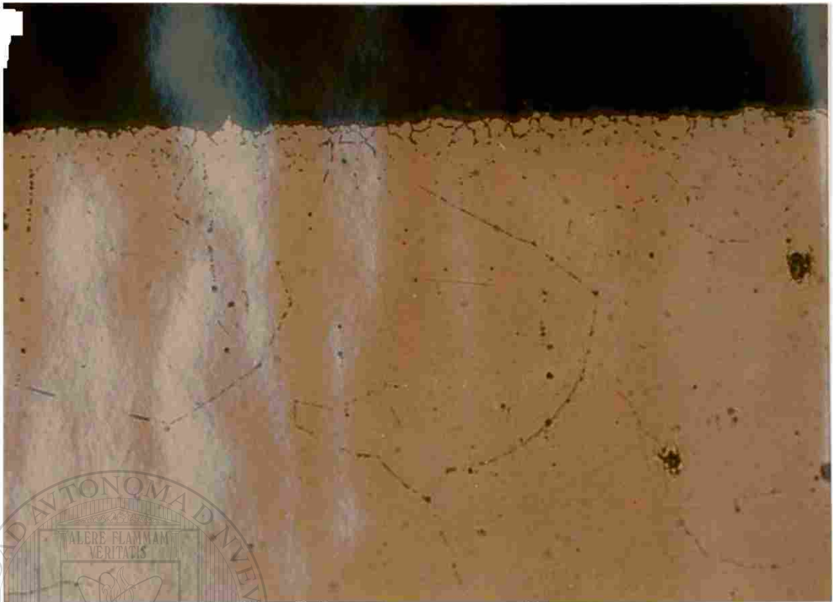
Figura. 17.- Acero AISI 304 (400 X) a 800 °C ( Vista de capa oxidada y carburos preferenciales).
