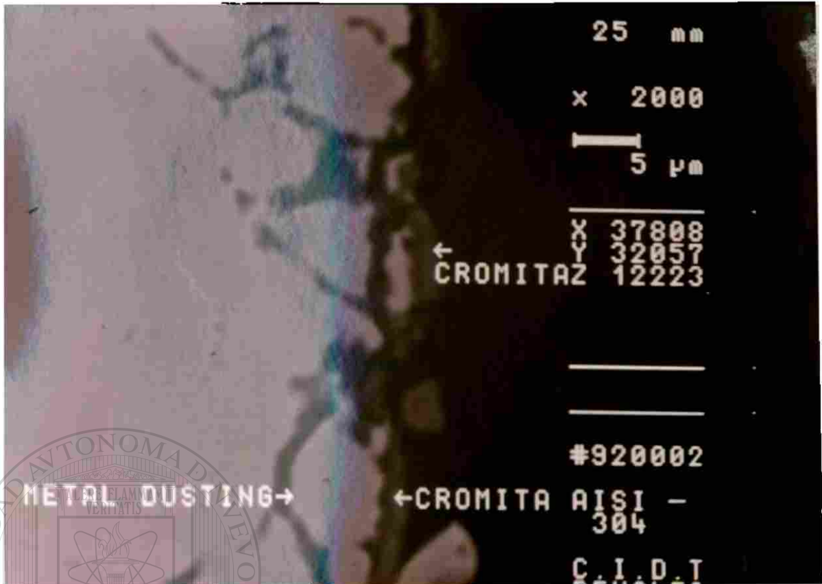
Figura 24. Zonas de cromita y carburos en límites de subgranos en un acero AISI 304 (2000X) SEM.
