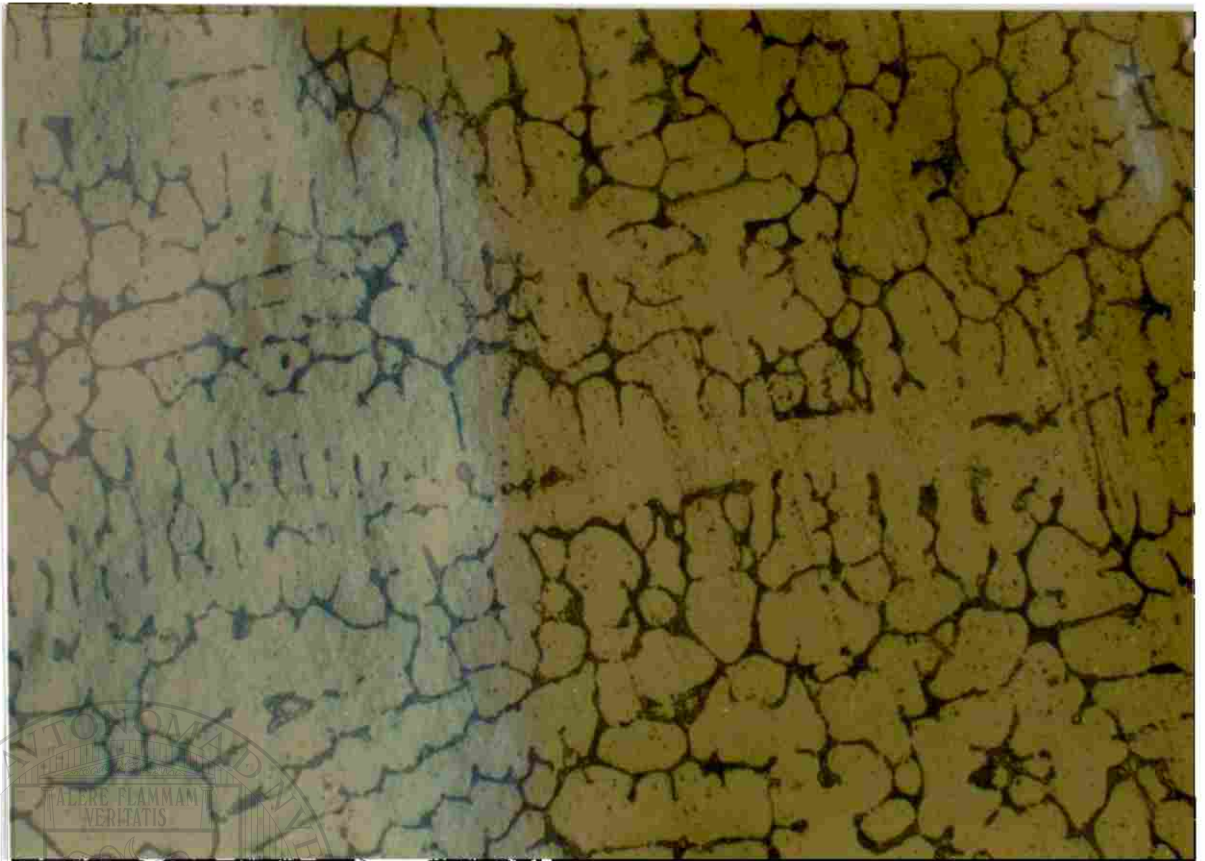
Figura 11. Estructura del acero HP40 + Nb.(100X, Ataque electrolítico)
