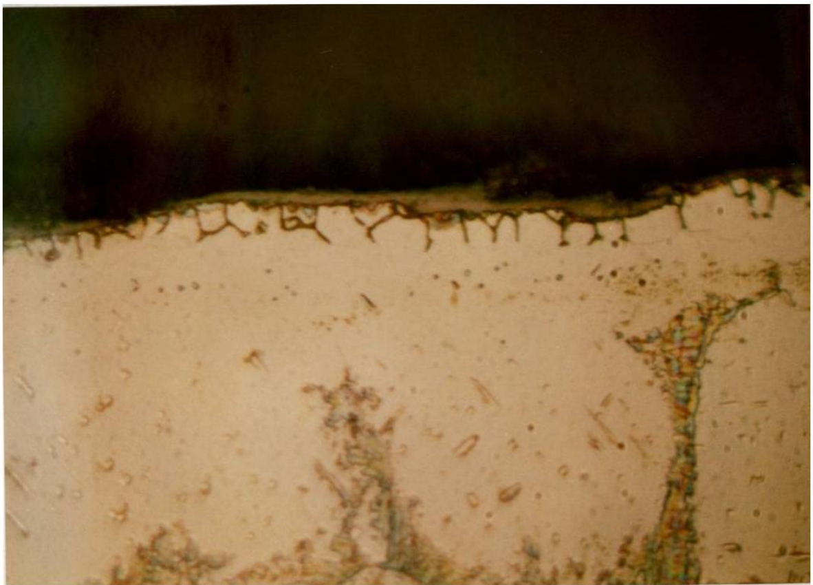
Figura 18.- Acero HP40 + Nb. (1000 X) a 800 °C. ( Vista de óxido y carburos preferenciales).
