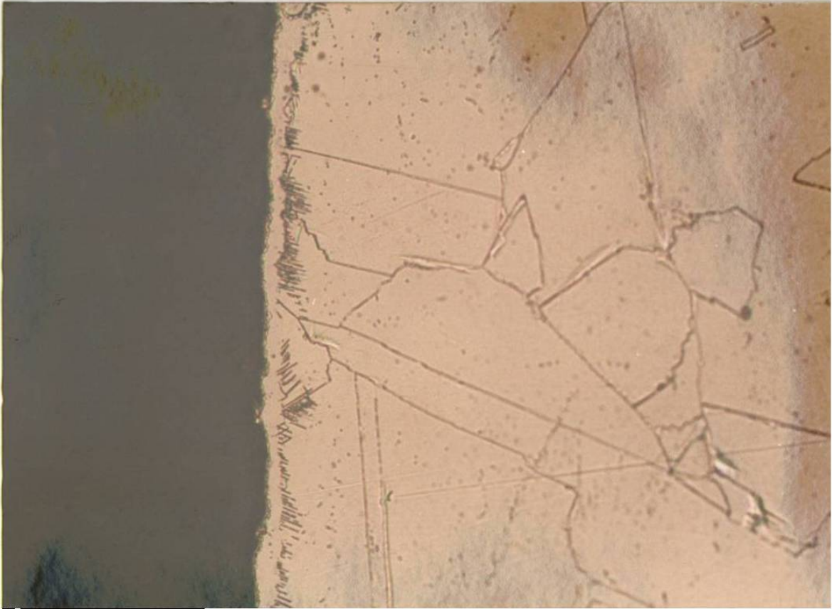
Figura 27. Carburización interna en aceros AISI 304 ( 400 X ). Atacada electrolíticamente.
