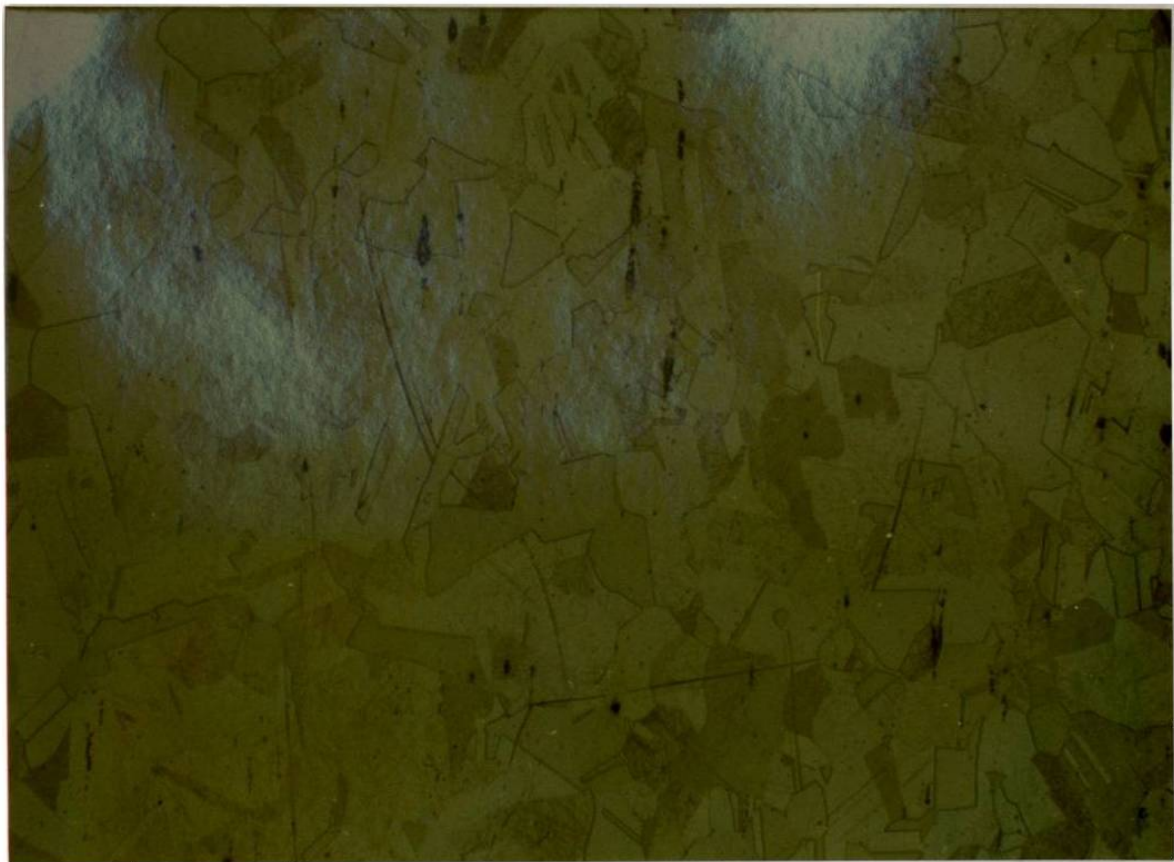
Figura 10. Estructura del acero AISI 304. ( 100X, ataque electrolítico ).
