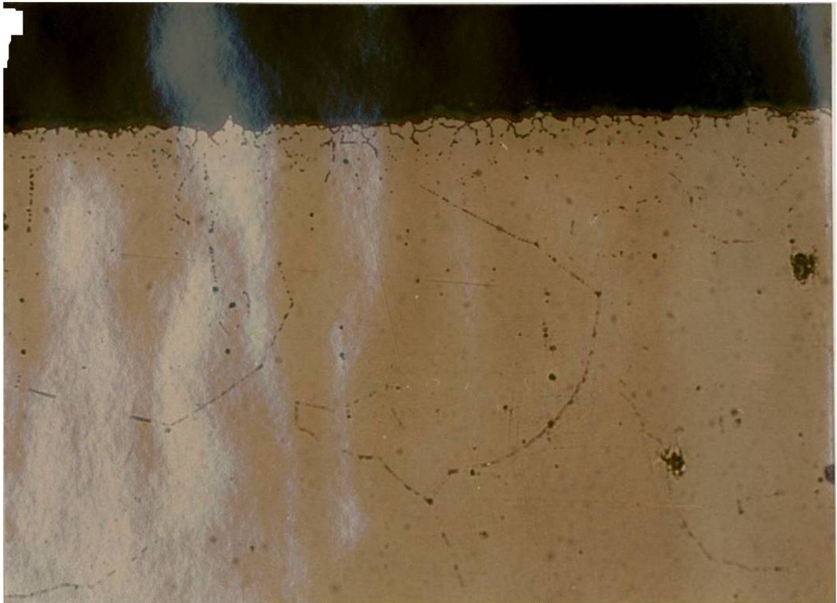
Figura. 17.- Acero AISI 304 (400 X) a 800 °C ( Vista de capa oxidada y carburos preferenciales).
