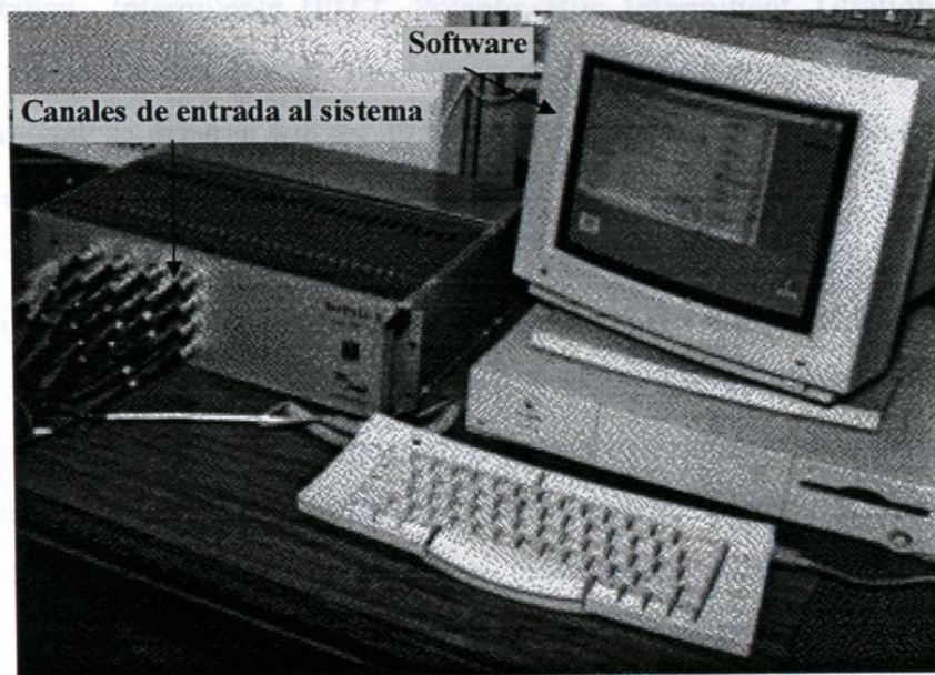
Figura 9. Sistema multicanal potencioestato-galvanostato tipo MacPile (Depto. Electroquím., CIDEMAC).
