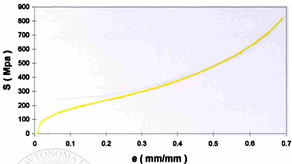
**Fig. A3 Gráfica esfuerzo-deformación ingenieril de la muestra en la condición sobresaturado.**
