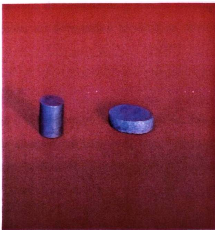
Fig. 5.6 Muestra antes de comprimirla comparada con una deformada un 70 %
