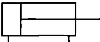
Actuador lineal de acción doble con amortiguamiento en un extremo
