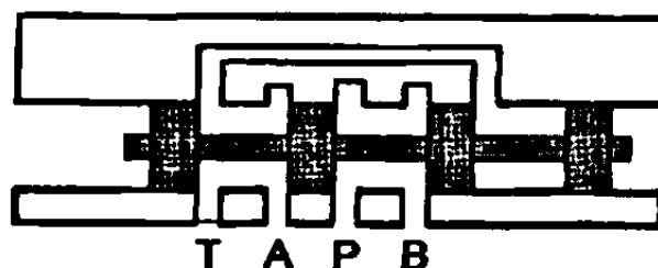
Figura 10.37 Cuerpo de válvula de cuatro vías, montada sobre una placa base, con conmutador de cuatro émbolos
