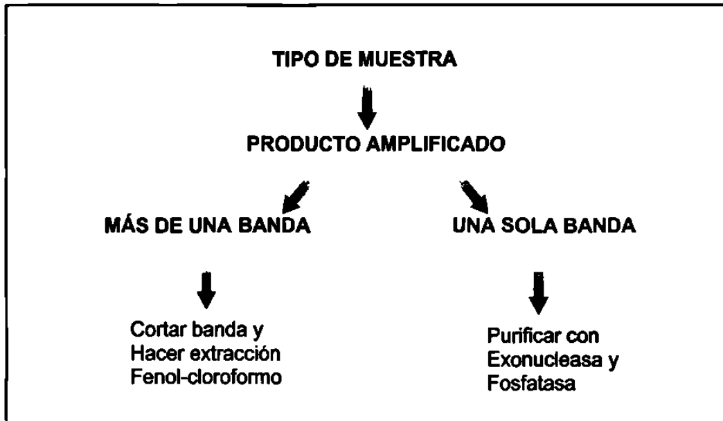
Figura 9.- Esquema para la purificación de los PA.- El método de purificación depende de la calidad del PA, si son PAs con una sola banda se purifican utilizando exonucleasa y fosfatasa alcalina, si son PAs con muchas inespecificidades se corren en geles de agarosa, se corta la banda, se pasa la agarosa por fibra de vidrio y se realiza una extracción fenol-cloroformo.
