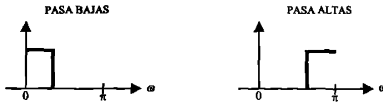
Figura 2.11. Respuesta característica ideal de los filtros digitales.
