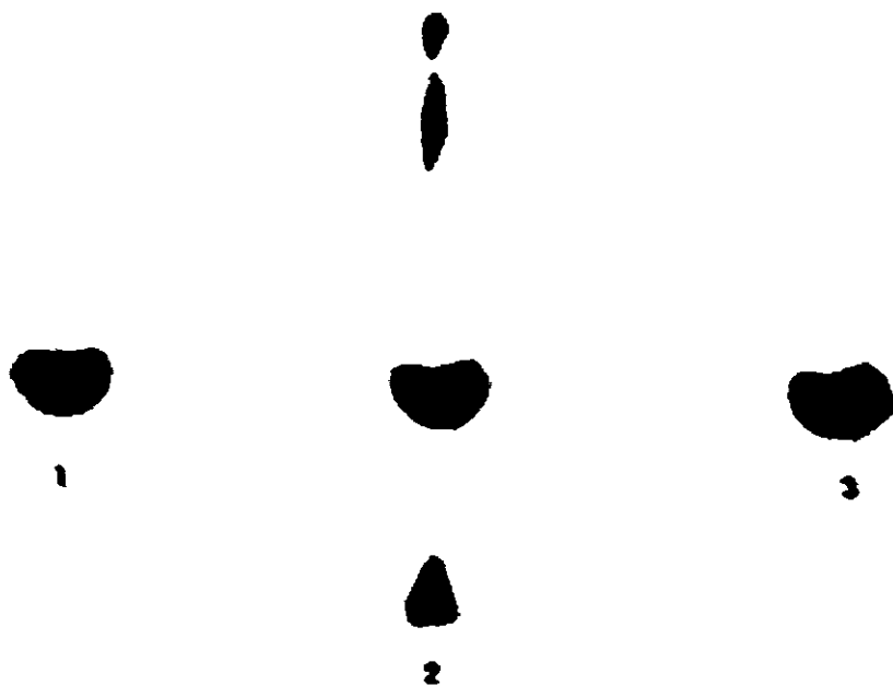
Fig. 3 Cromatograma para la identificación del producto de la reacción aspartatoamoníacoliase. 1- control (aminoácido L-aspártico de grado analítico), 2 – mezcla de aminoácidos: histidina, lisina, ácido L-aspártico (producto de reacción), tirosina y triptofano, 3 – producto de la reacción aspartatoamoníacoliase (ácido L-aspártico).
