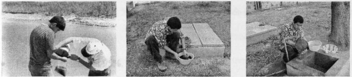
Figura VI-8. a) Izquierda, vertido en bolsas; b) centro, lavado y cribado de muestras; c) derecha, preservación en alcohol al 95%.
