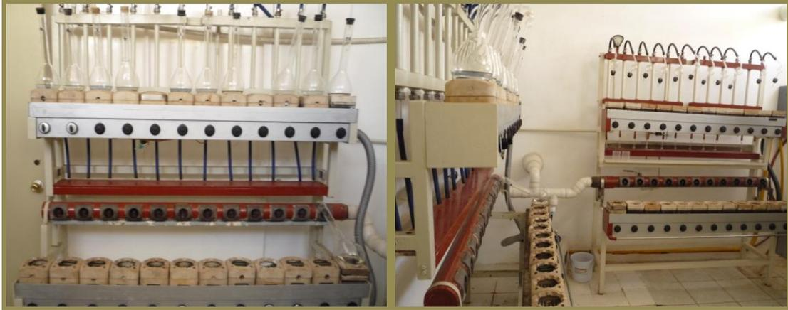
**Figura 12.-** Determinación de proteínas (Kjeldal)
